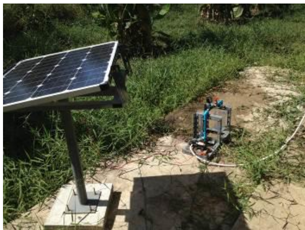
ชุดทดลองความสัมพันธ์ระหว่างความเข้มแสงกับอัตราการไหลของเครื่องสูบน้ำพลังงานแสงอาทิตย์
